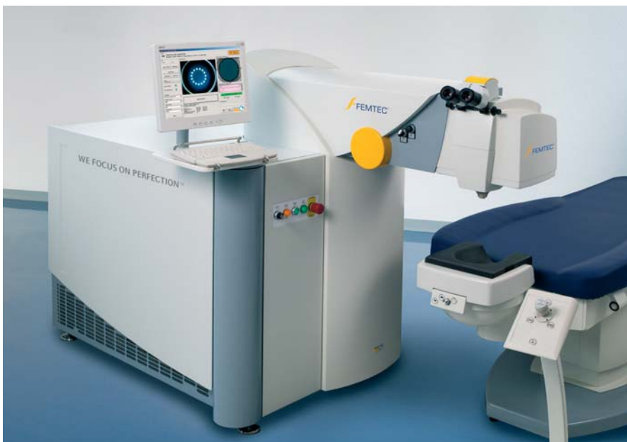
Der Femtosekundenlaser ist ein fester Bestandteil in der Laserchirurgie am Auge
